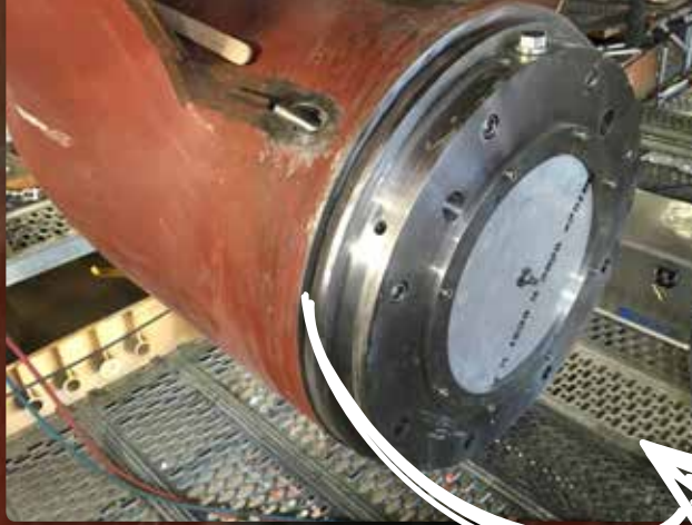
Sellado del eje de un anillo (eje de transmisión de un barco) Uretano 80 Putty
