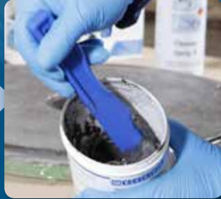
Mezclar resina y endurecedor evitando la formación de burbujas
