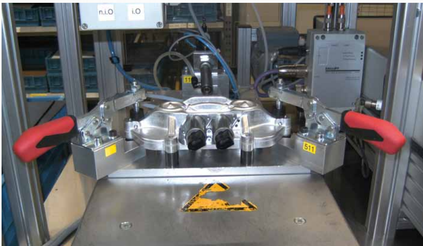
Grampo fixador horizontal nº 6830 aplicado num dispositivo para verificação da estanqueidade. O aperto é exercido sobre um componente para ajuste da árvore de cames.
