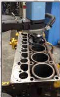
Werkzeugaufnahme mit 3 Wendeschneidplatten
