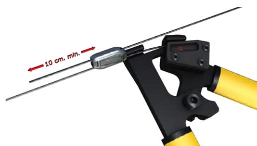
Fig. 1 Tensionamento do arame
